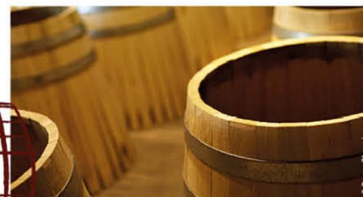
Nel laboratorio di Couchey, i nostri artigiani producono barrique e tonneaux con capacità da 114 a 600 litri. Divise in più gamme, ognuna con le proprie specificità (legno, venature, tostatura), le barrique Rousseau possono soddisfare diverse esigenze tecniche in termini di affinamento.
